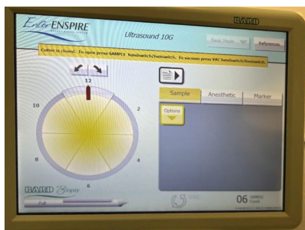
Рис. 5. Монитор биопсионного устройства. Установлен режим Вращения зонда вокруг собственной оси.
