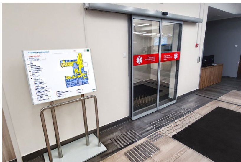
Рис. 1. Тактильная плитка и мнемосхема при входе в здание (Красноярский край).
